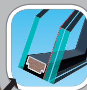
Vidrio laminado y anti intrusión clase P2 – composición de vidrio: vidrio exterior templado y capa de fácil limpieza y el vidrio interior laminado. El interior relleno con gas noble. Marco aislante TGI.
