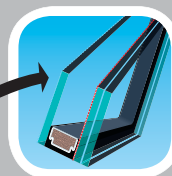
VIDRIO LÁMINADO Y ANTI INTRUSIÓN CLASE P2A - vidrio exterior templado con capa de fácil limpieza y el interior laminado. El vidrio interior relleno con gas noble. Marco aislante TGI.
